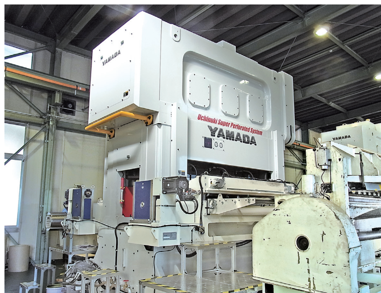
導入した最新鋭の220トンの高速プレス機。精度、生産性が大幅に向上
